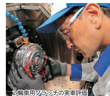
2輪車用クラッチの実車評価
